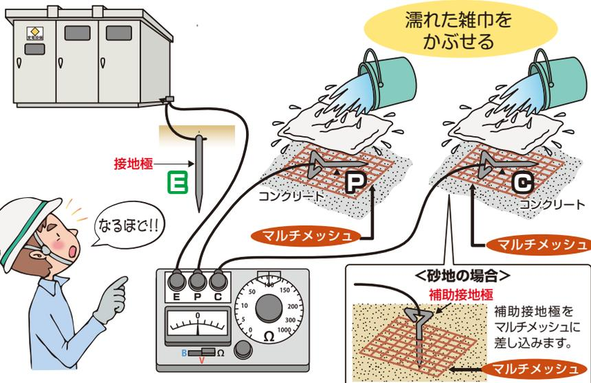
地表がコンクリートや砂れきなどで補助接地棒が打ち込みできない場合マルチメッシュを置き、十分に濡れた雑巾などを被せ地表と密着させます。
